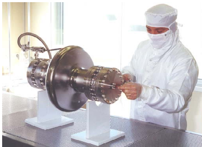
Assemblage final d'une cavité 700 MHz en salle blanche à Saclay
