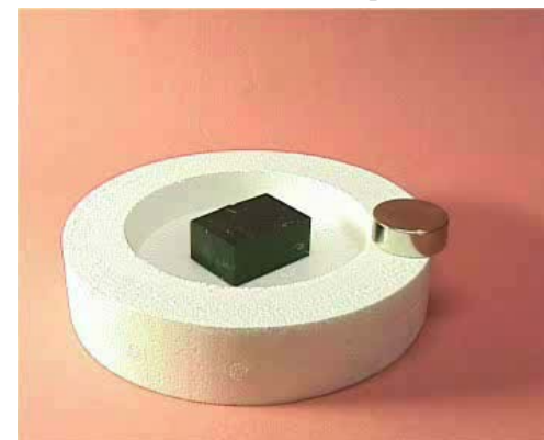
L'expérience de l'aimant flottant : un aimant entre en lévitation au-dessus d'une pastille d'YBaCuO
