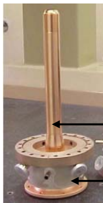
Le coupleur de puissance des cavités à protons SNS (Jefferson Lab.)
