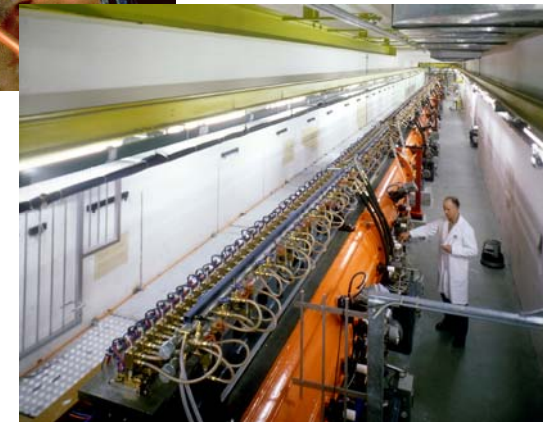
DTL Linac 2, (CERN, 1978) : 202 MHz, p 50 MeV
