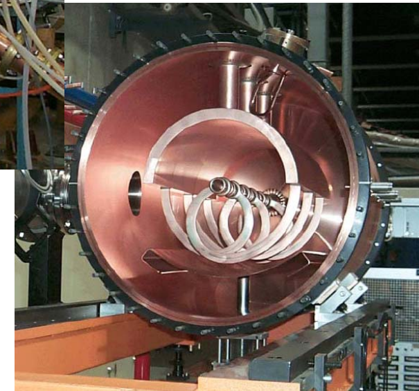
Résonateur 7-gap (Rex-Isolde), 101.3 MHz
