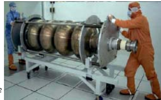
Cavité Nb/Cu 4 cellules – 352 MHz – 1,7 m (CERN → LEP)
