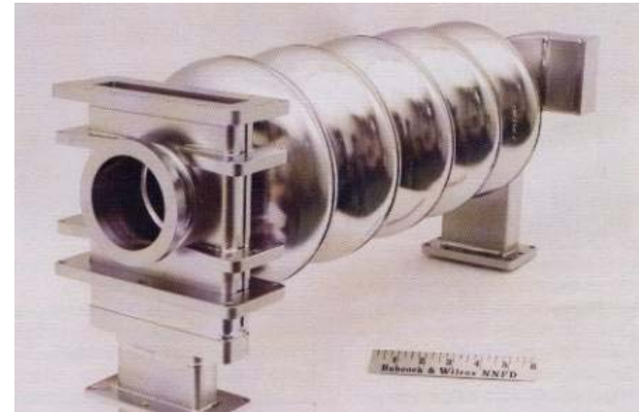
Cavité Nb 5 cellules – 1,5 GHz – 0,5m (Cornell → CEBAF)
