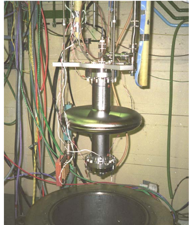
Cavité 700 MHz sur son insert avant encuvage à Saclay
