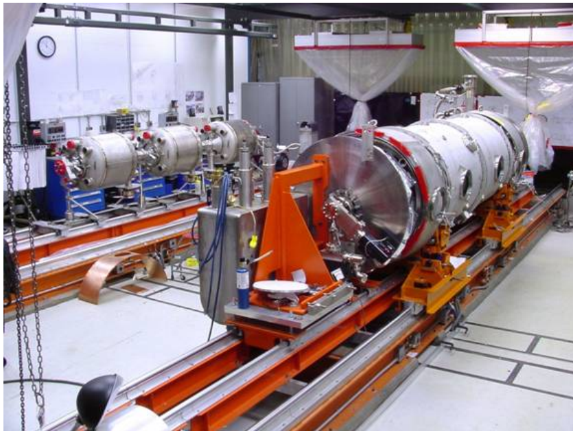
Exemple d'assemblage de cryomodule (SNS)
