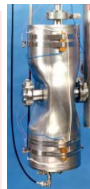
Résonateur demi-onde (Argonne) 355 MHz - \beta = 0,12
