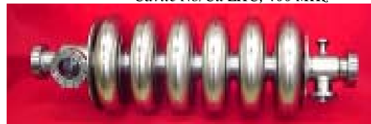
Cavité Nb à protons 805 MHz (Jef. Lab → SNS)
