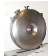
Cavité ré-entrante (Legnaro) 352 MHz - \beta \geq 0,1
