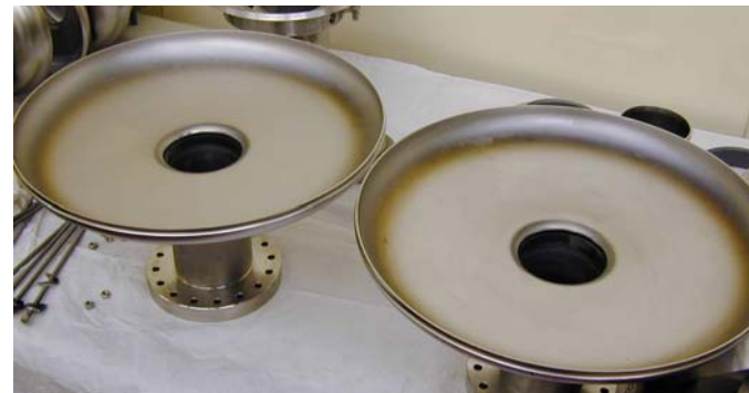
Demi-cellules \beta=0,47 après formage et polissage (Zanon, Italie)
