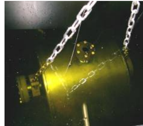
Chimie au « trempé » sur une cavité spoke 352 MHz au CEA Saclay
