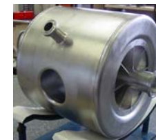
Cavités spoke (CNRS Orsay) 352 MHz - \beta = 0,15 et 0,35
