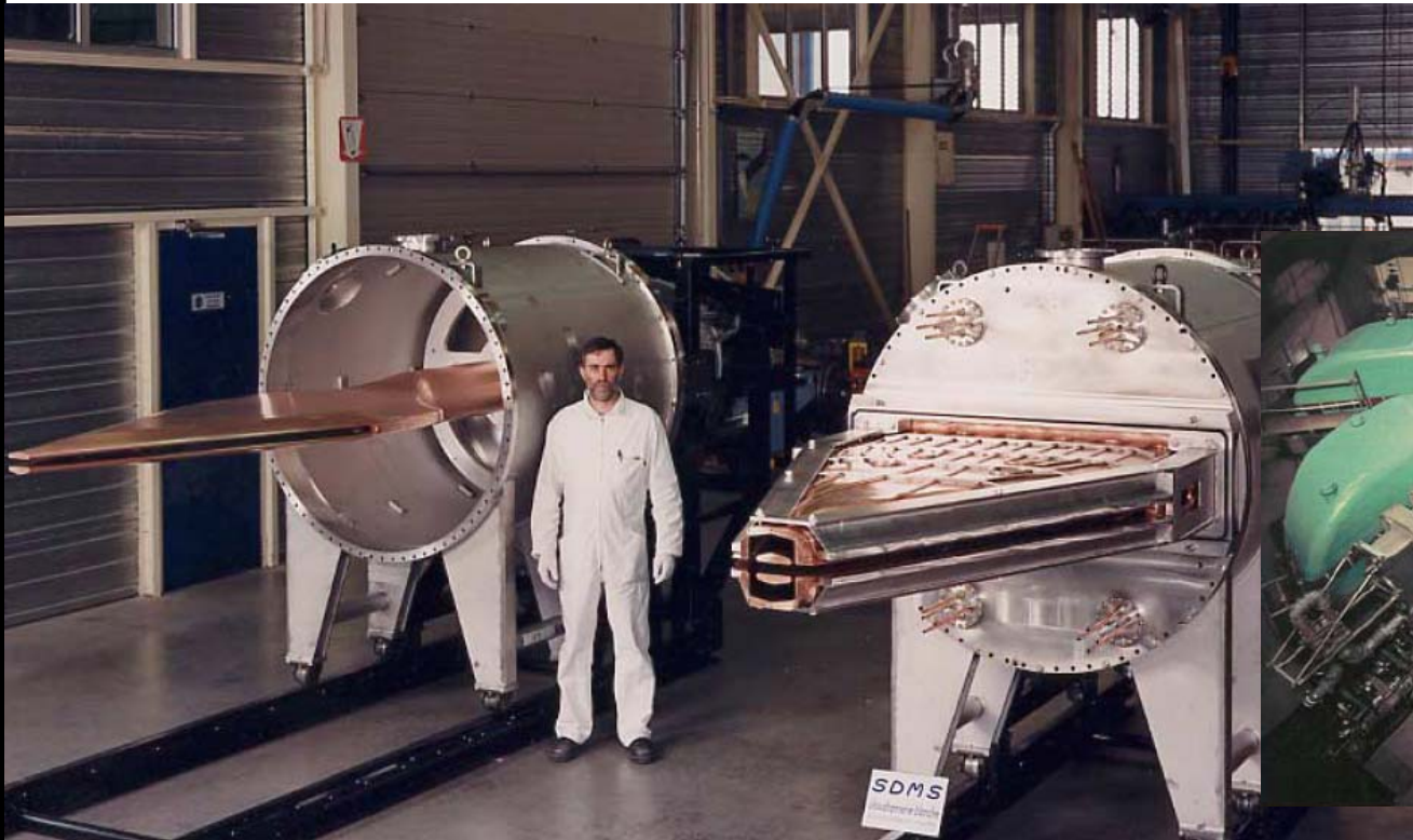
Cavités du cyclotron CIME (GANIL, 9.6 – 14.5 MHz, V_{\max}=100\text{kV} )
